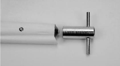
Ziehen Sie nun die Dichtung mit einer Zange aus der Spitze. Schauen Sie in der Spitze und im Handstück nach, ob sich dort noch Teile der Dichtung befinden und entfernen Sie diese gegebenenfalls. Drücken Sie nun die neue Dichtung von oben in die Spitze.
