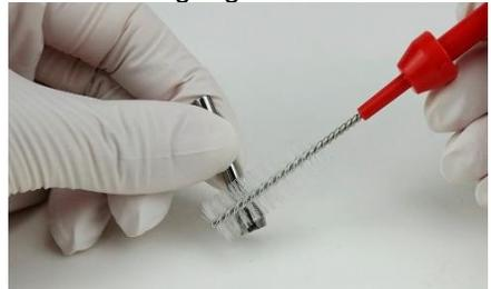
Drücken Sie mit der Reinigungsbürste alle Schmutzrückstände aus der Bohrung:
