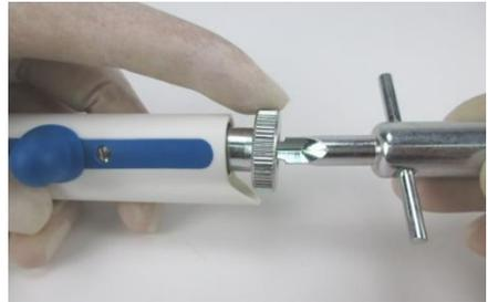
Die Montage der Spannzange erfolgt in umgekehrter Reihenfolge. Achten Sie darauf, dass die Spannzange bei der Montage geöffnet ist (Knopf nach vorne schieben) und richtig angezogen wird.
