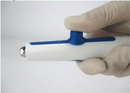
Stecken Sie den runden Achsenschlüssel auf die Achse und halten Sie ihn fest. Drehen Sie mit der spitzen Seite des Zangenschlüssels die Spannzange heraus:
