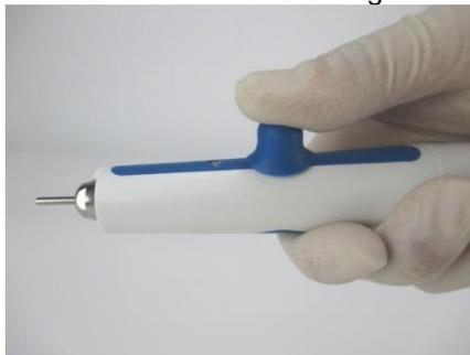
Führen Sie nun das Werkzeug bis zum Anschlag ein. Ziehen Sie den Knopf zurück und das Werkzeug wird gespannt.
